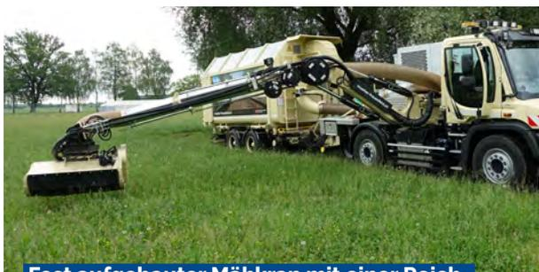
**Fest aufgebauter Mähkran mit einer Reichweite von 7,5 m**
